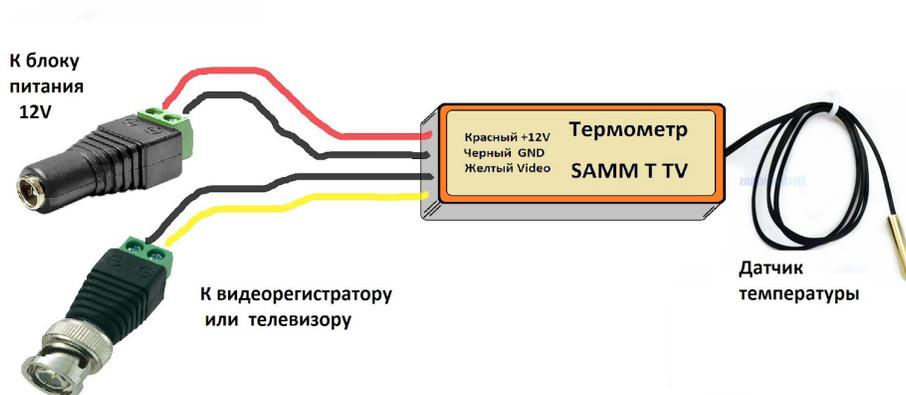
Прибор производит измерение температуры с высоким разрешением. На экран выводятся график, отображающий динамику изменения в течении последних минут.
